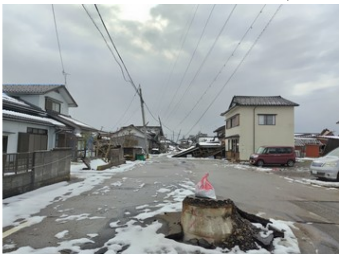
マンホールは浮き上がっているものの, それ以外では液状化の痕跡は見当たらない 道路1本北側では大きな被害がない
