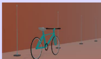
図10 盗難自転車受信アンテナ ・自転車についてのRFタグを検知し、自転車の位置を特定する
